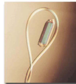
Sample Mount Pin & Cryoloop
